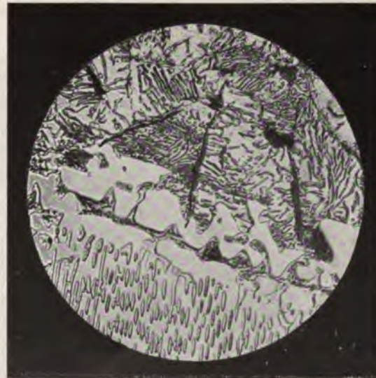
Fig. 141. Halbiertes Roheisen. Grenze zwischen weißem und grauem, graphithaltigem Material. Weiß unten: Cementit hell, von kleinen Perlitinseln zerteilt. Grau oben: Graphitadern, umgeben von lamellarem Perlit.
